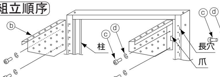
1 ULRLE型本体の柱の長穴に、上棚側板㊧の爪を引っ掛け(左右注意)、SW㊩とキャップボルト㊨を差し込み、六角レンチ(対辺4)でしっかり締め付けて下さい(2カ所)。反対側の柱にも、高さを合わせて同様に上棚側板㊧を取り付けて下さい。
