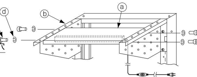
2 上棚㊦の穴を上棚側板㊧の穴に合わせ、外側からSW㊩とキャップボルト㊨を差し込み、六角レンチ(対辺4)でしっかり締め付けて下さい(4カ所)。
