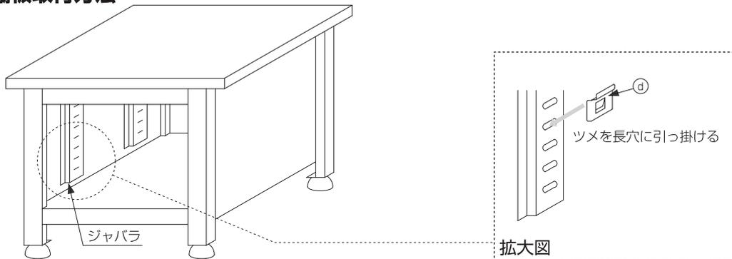
1. 本体の側板のジャバラの長穴に、棚板取付金具④のツメを引っ掛けて下さい。(4ヶ所)
