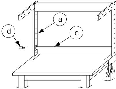
3 下補強⑤を支柱③の下部にはめ込み、穴を合わせて外側から段付ボルト④を差し込み、仮止めして下さい(左右各1カ所)。
