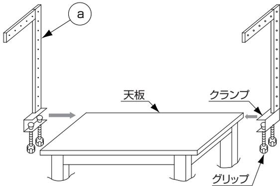
1 支柱③のクランプのグリップを天板の厚みほど緩めておき、図のように作業台の両側から天板に挟み込み、グリップを締め付けて下さい(左右各2カ所)。
