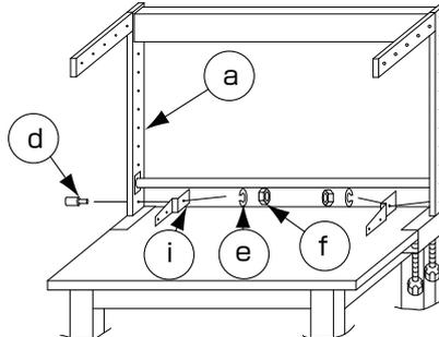
4 支柱取付金具①を、支柱③の一番下段の穴に内側から合わせ、外側から段付ボルト④を差し込み、内側からSW(M6)⑤とナット⑥で仮止めして下さい(左右各1カ所)。
