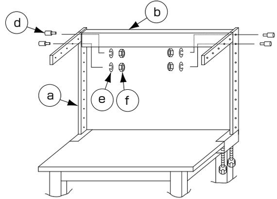
2 上補強④を支柱③の上部にはめ込み、穴を合わせて外側から段付ボルト④を差し込み、内側からSW(M6)⑤とナット⑥で仮止めして下さい(左右各2カ所)。
