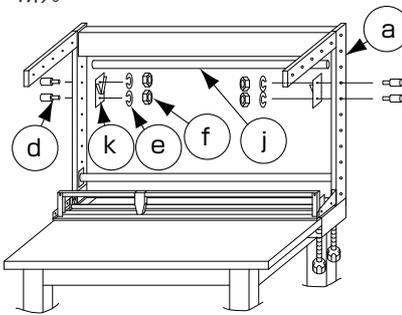
7 ロール棒取付金具③を、支柱③の任意の穴に内側から合わせて、外側から段付ボルト④を差し込み、内側からSW(M6)⑤とナット⑥でしっかり締め付けて下さい(左右各2カ所)。
