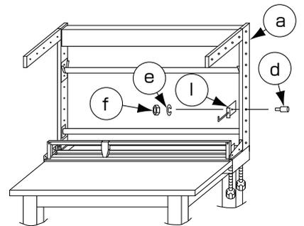
8 テープ掛け①を、支柱③の任意の穴に内側から合わせて、外側から段付ボルト④を差し込み、内側からSW(M6)⑤とナット⑥でしっかり締め付けて下さい(1カ所)。
