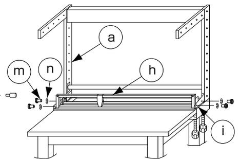
5 スライドカッター台②を、4で取り付けた支柱取付金具①の穴に合わせて、外側からキャップボルト⑨とSW(M5)⑩で仮止めして下さい(左右各2カ所)。
