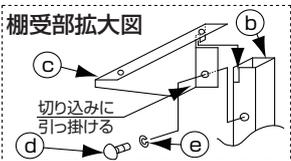
2 支柱②の切り込みに、棚受③の爪を引っ掛け、穴を合わせてトラスネジ④とSW⑤でしっかり締め付けて下さい(1カ所)。もう1枚の棚受③も同様に取り付けて下さい。
