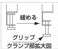
1 支柱②のクランプのグリップを天板の厚みほど緩めて下さい(左右各2カ所)。
