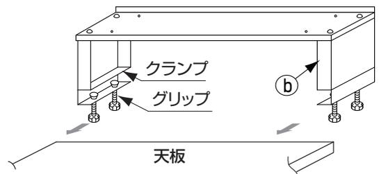
3 支柱②のクランプを、作業台の天板の後方よりスライドさせながらはめ込み、グリップを締め付けて下さい(左右各2カ所)。
