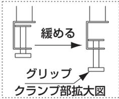
1 支柱②のクランプのグリップを天板の厚みほど緩めて下さい(左右各2カ所)。
