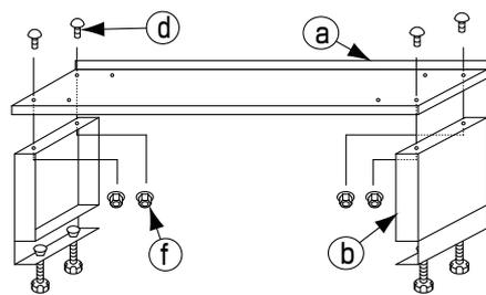
2 上棚①の穴(外側左右各2カ所)を支柱②の上部の穴に合わせ、上棚①の表面からトラスネジ③を差し込み、裏面からフランジナット④で仮止めて下さい(左右各2カ所)。
