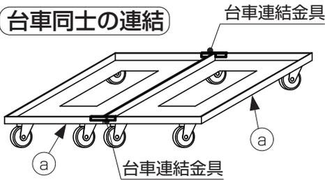
台車本体(a)同士を図のようにくっつけ、台車連結金具の中央の切り込みを内側にし、2台の台車本体(a)の折曲げ部分を切り込みで挟み込み、連結させて下さい(2ヶ所)。
