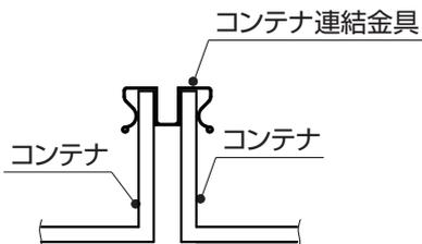
コンテナを載せた2台の台車を隣り合わせにし、2つのコンテナの上からコンテナ連結金具で挟み込み、連結させて下さい。
